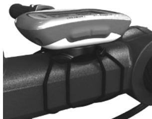
Edge instalovaný na rámové tyči
